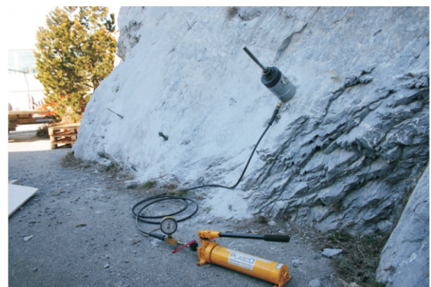
Im Fels versetzte Ankerhülse mit Ankerstange
